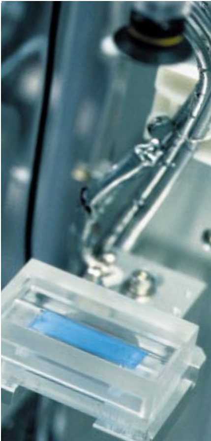
Produktionseinheit zur radioaktiven Beschichtung von Ballonkathetern
