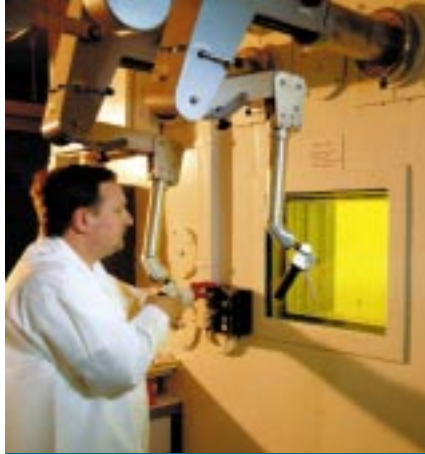
Heiße Zelle zur Lagerung radioaktiver Substanzen
